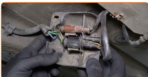
**6** Separe el conector del sensor de oxígeno.
