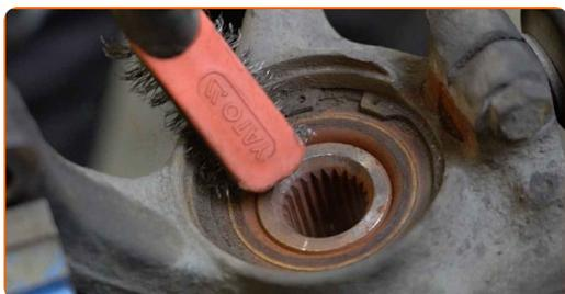
**33** Retire el anillo de retención del cojinete del cubo de rueda. Utilice alicates para arandelas.
