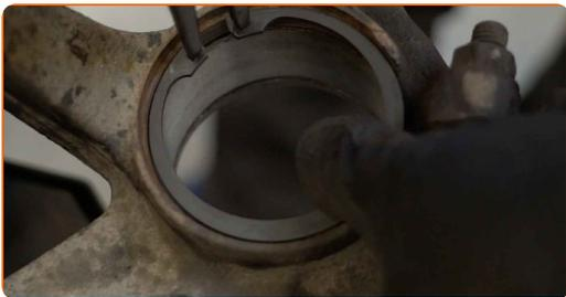
**42** Inserte presionando el rodamiento nuevo en el muñón de dirección. Utilice un juego de cubos y rodamientos.
