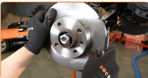
**65** Apriete la fijación del disco de freno. Utilice Torx T30. Utilice una llave dinamométrica. Apriételo a un par de 4 Nm.
