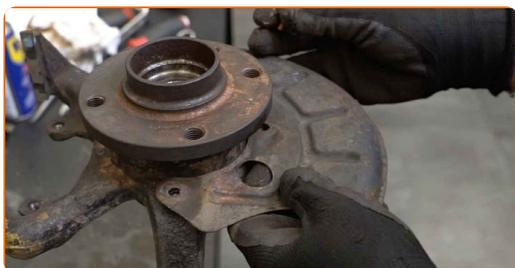
**49** Atornille las sujeciones de la cubierta del disco de freno. Usa una llave mixta del n.º 10.
