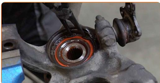
**34** Suelte el tornillo de banco y retire la mangueta de dirección ensamblada con el cubo de rueda.
