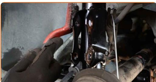
**53** Tratar las acanaladuras de la junta homocinética del eje de transmisión. Use un cepillo de alambre. Use el aerosol WD-40.
