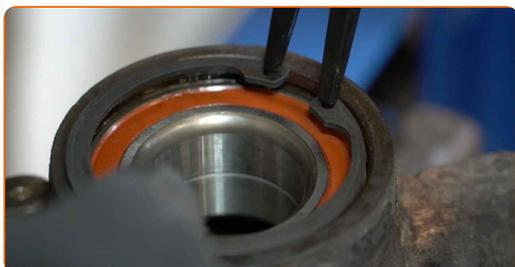
**44** Limpie el asiento de montaje del cubo de rueda. Use el aerosol WD-40.
