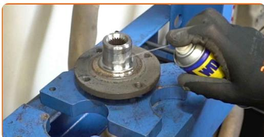
**45** Instale el cubo de rueda en el muñón de dirección. Utilice un juego de cubos y rodamientos.
