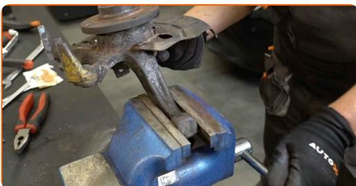
**52** Trate el asiento de montaje del puntal amortiguador en la mangueta de dirección. Use un cepillo de alambre. Use el aerosol WD-40.
