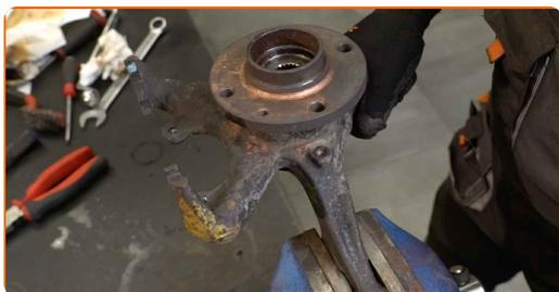
**47** Limpie el asiento de montaje de la cubierta del disco de freno. Use un cepillo de alambre. Use el aerosol WD-40.
