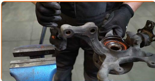
**35** Saque el cubo de rueda del muñón de dirección. Utilice un juego de cubos y rodamientos.
