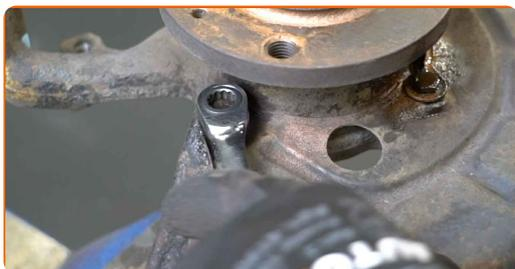
**31** Retire la cubierta del disco de freno.
