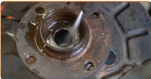
**51** Suelte el tornillo de banco y retire la mangueta de dirección ensamblada con el cubo de rueda.
