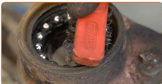
**37** Retire el anillo de retención del cojinete del cubo de rueda. Utilice alicates para arandelas.
