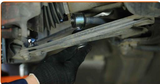
**11** Apriete la sujeción que conecta la barra estabilizadora con el brazo de control. Use un vaso de impacto del n.º 13. Utilice una llave dinamométrica. Apriételo a un par de 25 Nm.
