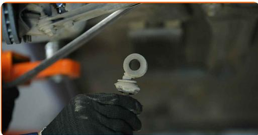
**9** Limpie los asientos de montaje de la bieleta de barra estabilizadora. Use un cepillo de alambre. Use el aerosol WD-40.
