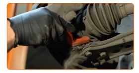
Desenrosque la fijación que conecta la rótula al brazo de control de la suspensión. Use un vaso de impacto del n.º 13. Utilice una llave giramachos.
