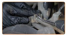
Desconecte el cableado del captador ABS.
