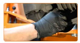
Desenrosque la fijación que conecta el eje de transmisión al cubo de la rueda. Use un vaso de impacto del n.º 36.
