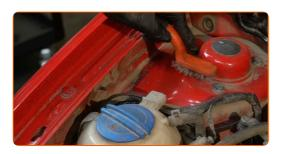
Afloje la sujeción superior del soporte del amortiguador. Use un vaso de impacto del n.º 13. Utilice una llave de trinquete.
