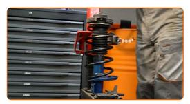
Retire el puntal amortiguador que está montado.
