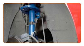
Apriete la sujeción que conecta la bieleta de barra estabilizadora al amortiguador. Use un vaso de impacto del n.º 17. Utilice una llave dinamométrica. Apriételo a un par de 40 Nm.
