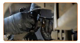
Suelte la sujeción inferior que conecta el puntal amortiguador a la mangueta de dirección. Utilice un vaso de impacto especial para extraer el amortiguador. Utilice una llave de trinquete.
