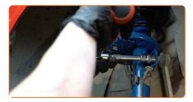
Trate las sujeciones del amortiguador. Trate todas las articulaciones del brazo. Use grasa de cobre.
