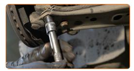
Apriete la fijación del soporte esférico. Use un vaso de impacto del n.º 13. Utilice una llave dinamométrica. Apriételo a un par de 20 Nm.+90°
