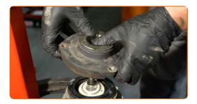
Sustitución: copelas del amortiguador - VW Polo Hatchback (6N1). AUTODOC recomienda:
