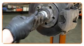
Apriete la tuerca del eje de transmisión. Use un vaso de impacto del n.º 36. Utilice una llave dinamométrica. Apriételo a un par de 50 Nm.+45°
