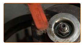
Destornille la tuerca de la varilla de la pata amortiguadora. Use Vaso HEX No. H6. Use un vaso de impacto del n.º 21. Utilice una llave de trinquete.
