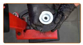
Apriete la tuerca de la varilla de la pata amortiguadora. Use Vaso HEX No. H7. Use un vaso de impacto del n.º 21. Utilice una llave dinamométrica.
