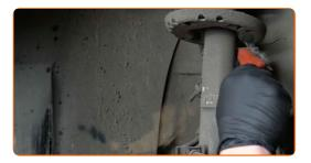
Desatornille la sujeción que conecta la bieleta de barra estabilizadora al amortiguador. Use un vaso de impacto del n.º 17. Utilice una llave de trinquete.
