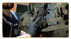
27 Sostenga el muñón de dirección. Utilice un gato de transmisión hidráulica.
