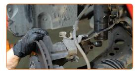
Destornille la fijación superior de la cazoleta de la pata amortiguadora.
