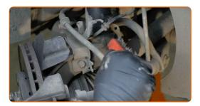
Desatornille la sujeción inferior que conecta el puntal amortiguador a la mangueta de dirección. Utilice las puntas XZN #14. Use un vaso de impacto del n.º 18. Utilice una llave de trinquete. Utilice una llave giramachos.
