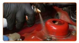
Instale el tapón protector del soporte de la pata amortiguadora.
