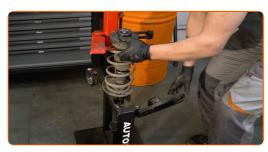
Sustitución: copelas del amortiguador - VW Polo Hatchback (6N1). Consejo de los expertos de AUTODOC:
