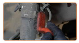
Retire el clip de retención del latiguillo de freno.
