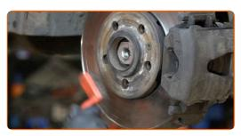
Trate la superficie donde el disco del freno entra en contacto con la llanta de la rueda. Use grasa de cobre.
