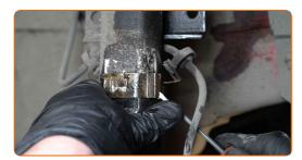
Desconecte el latiguillo de freno. Use una palanca.
