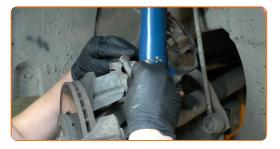
Instale el clip de retención del latiguillo de freno.
