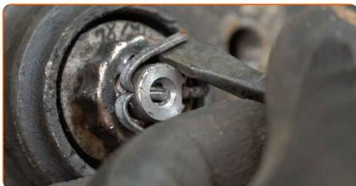
**8** Desenrosque la tuerca del cubo. Use un vaso de impacto del n.º 30. Utilice una llave de trinquete.
