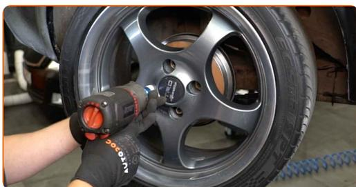
**20** Baje el automóvil y, manteniendo el orden cruzado, apriete los pernos de fijación de las ruedas. Utilice una llave de impacto para llanta # 17. Utilice una llave dinamométrica. Apriételo a un par de 110 Nm.
