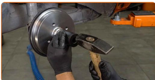
**17** Trate la superficie en la cual la llanta de la rueda entra en contacto con el tambor del freno. Use grasa de cobre.
