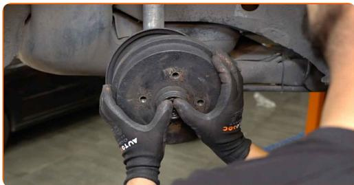
**11** Limpie el asiento de montaje del cojinete del cubo (buje). Utilice un spray de limpieza multiuso.
