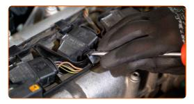
Levante la bobina de ignición haciendo palanca. Utilice un destornillador plano.
