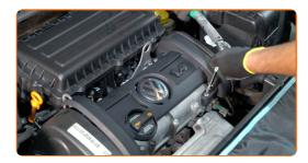
Conecte la manguera de ventilación del cárter.
