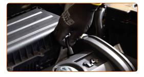
4 Afloje los tornillos de la tapa del motor (4 piezas).
