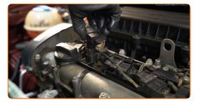
9 Desconecte el conector de la bobina de ignición.
