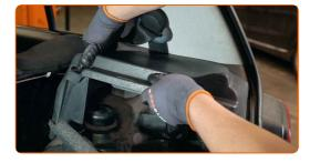
Atornille las sujeciones del panel de plástico del revestimiento lateral. Utilice Torx T20. Use un vaso de impacto del n.º 7. Utilice una llave de trinquete.
