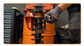
Trate la varilla del amortiguador. Use grasa de cobre.
