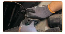
Limpie la sujeción superior del soporte del puntal de suspensión. Use un cepillo de alambre. Use el aerosol WD-40.
