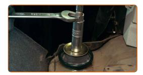
Desenrosque la sujeción superior del puntal de suspensión. Usa una llave mixta del n.º 17. Utilice un vaso para amortiguador DDNº5,2. Utilice una llave de trinquete.
