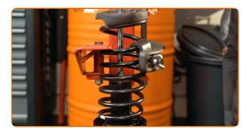
Instale el guardapolvo y el tope en el amortiguador nuevo.
