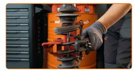
Trate la varilla del amortiguador. Use un cepillo de alambre. Use el aerosol WD-40.
