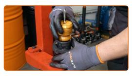
Instale el soporte de montaje superior del puntal y el cojinete del soporte de montaje del puntal.
