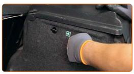
Separe el revestimiento de la parte lateral del maletero.
