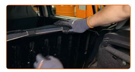
Desatornille las sujeciones del panel de plástico del revestimiento lateral. Utilice Torx T20. Use un vaso de impacto del n.º 7. Utilice una llave de trinquete.
