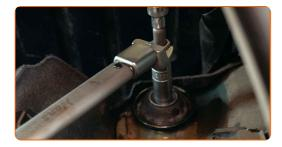
Apriete las sujeciones superiores del puntal de suspensión. Usa una llave mixta del n.º 16. Utilice un vaso para amortiguador DDNº5,2. Utilice una llave dinamométrica. Apriételo a un par de 20 Nm.
