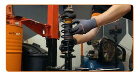
Limpie los asientos de montaje del amortiguador. Use un cepillo de alambre. Use el aerosol WD-40.
