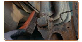
Desenrosque las sujeciones inferiores del puntal de suspensión. Usa una llave mixta del n.º 16. Use un vaso de impacto del n.º 16. Utilice una llave giramachos.
