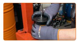
Apriete la tuerca de la varilla de la pata amortiguadora. Usa una llave mixta del n.º 17. Utilice un vaso para amortiguador DDNº5,2. Utilice una llave dinamométrica. Apriételo a un par de 20 Nm.
