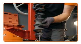
Retire el amortiguador viejo del compresor de muelles hidráulico.
