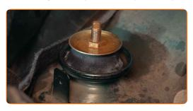
Instale la tapa del soporte del amortiguador.
