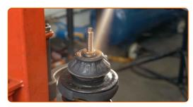
Retire el puntal amortiguador que está montado.
