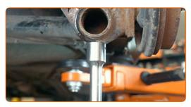
Apriete las sujeciones inferiores del puntal de suspensión. Usa una llave mixta del n.º 17. Use un vaso de impacto del n.º 17. Utilice una llave dinamométrica. Apriételo a un par de 55 Nm.
