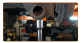
Limpie la sujeción inferior del puntal de suspensión. Use un cepillo de alambre. Use el aerosol WD-40.
