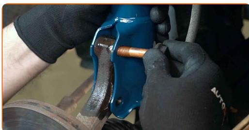
40 Atornille las sujeciones que conectan el puntal de suspensión con la mangueta de dirección. Usa una llave mixta del n.º 18. Use un vaso de impacto del n.º 18. Utilice una llave de trinquete.
