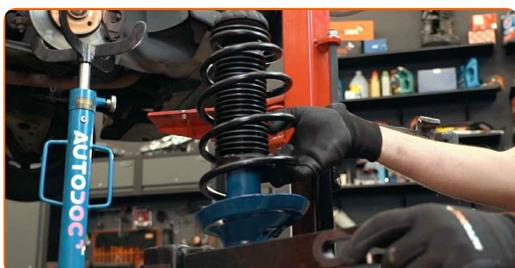
34 Trate la varilla del amortiguador. Use grasa de cobre.
