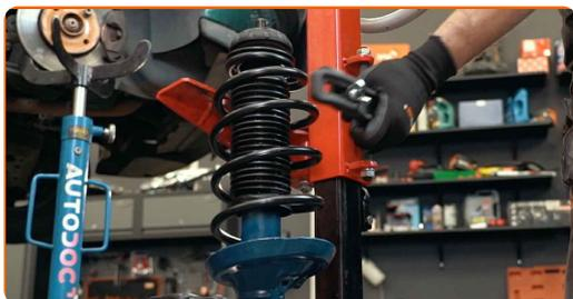
33 Retire el puntal amortiguador que está montado.
