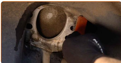
**20** Trate los asientos de montaje del amortiguador. Use grasa de cobre.
