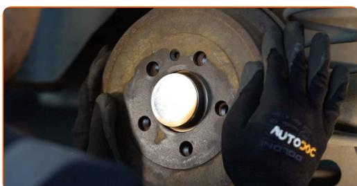
18 Apriete las sujeciones del tambor del freno. Utilice un destornillador Phillips. Utilice una llave dinamométrica. Apriételo a un par de 4 Nm.
