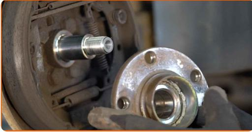
**12** Limpie el asiento de montaje del cojinete del cubo (buje). Utilice un spray de limpieza multiuso.
