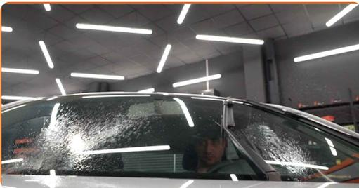
**5** Después de la instalación verifique el funcionamiento del limpiaparabrisas. Las escobillas no deben cruzarse o chocar con la compactación del cristal.
