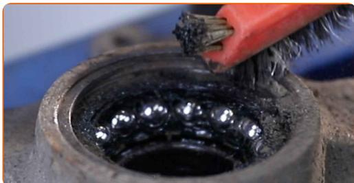
**35** Retire el anillo de retención del cojinete del cubo de rueda. Utilice alicates para arandelas.
