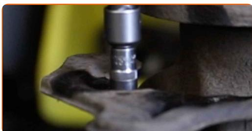
**32** Retire la cubierta del disco de freno.
