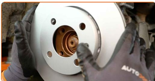
**70** Apriete la fijación del disco de freno. Utilice Torx T30. Utilice una llave dinamométrica. Apriételo a un par de 4 Nm.
