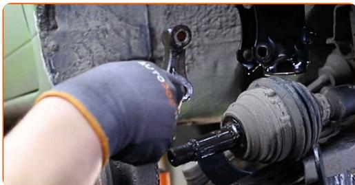
**30** Limpie las sujeciones de la cubierta del disco de freno. Use un cepillo de alambre. Use el aerosol WD-40.
