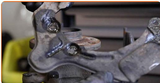
**33** Saque el cubo de rueda del muñón de dirección. Utilice un juego de cubos y rodamientos.
