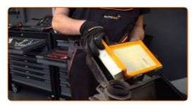
8 Limpie la cubierta y la carcasa del filtro de aire.
