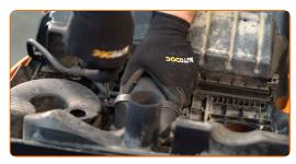
Atornille los tornillos de sujeción de la cubierta del filtro de aire. Utilice un destornillador Phillips.
