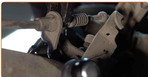
**13** Desconecte el cable del freno de estacionamiento del soporte. Use alicates de bomba de agua.
