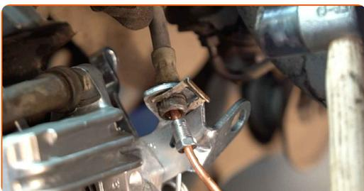
**25** Atornille la sujeción que conecta el tubo de freno al latiguillo de freno. Usa una llave mixta del n.º 13.
