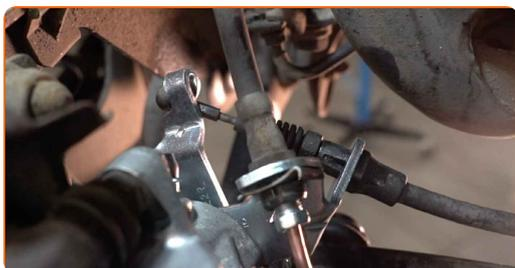
**29** Separe la tapa del tornillo de purga de la pinza de freno. Use una palanca.
