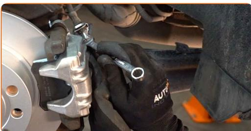
**26** Retire la abrazadera del latiguillo del freno.
