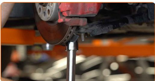
**21** Desconecte la bisagra esférica del brazo. Use una palanca.
