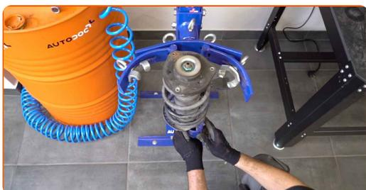
**Sustitución: copelas del amortiguador - VW SCIROCCO (137, 138). Consejo de los expertos de AUTODOC:**
