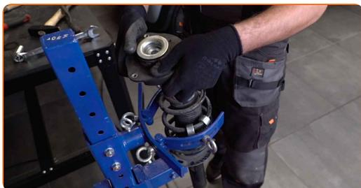
**35** Instale la nueva montura, fuelle y tope del amortiguador.
