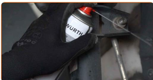
**17** Destornille la tuerca y quite la barra del estabilizador desde la pata amortiguadora. Usa una llave mixta del n.º 16. Utilice las puntas XZN #6. Utilice una llave de trinquete.
