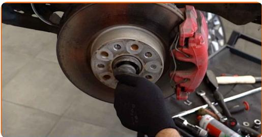
**19** Desenrosque la fijación que conecta la rótula al brazo de control de la suspensión. Use un vaso de impacto del n.º 16. Utilice una llave de trinquete.
