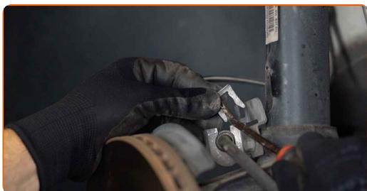
**16** Limpie las fijaciones que conectan la bieleta de la barra estabilizadora al puntal amortiguador, y aquellos que conectan el puntal del amortiguador a la mangueta de rueda. Use un cepillo de alambre. Use el aerosol WD-40.
