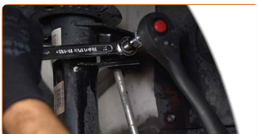
**18** Desenrosque la fijación que conecta el eje de transmisión al cubo de la rueda. Utilice un vaso de 12 puntos # 24.
