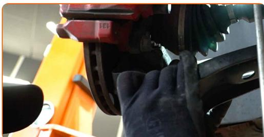
**45** Apriete la tuerca de fijación del soporte esférico. Use un vaso de impacto del n.º 16. Utilice una llave dinamométrica. Apriételo a un par de 60 Nm.
