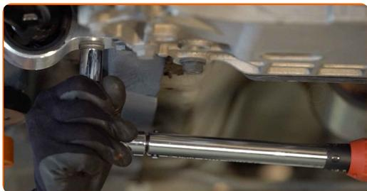
**Sustitución: brazo inferior de la parte delantera - VW SCIROCCO (137, 138).
