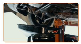
Limpie el área del orificio de drenaje de la bandeja de aceite. Limpie el filtro de aceite. Use un cepillo de alambre. Utilice un spray de limpieza multiuso.
