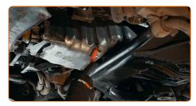
Destornille el tapón de desagüe. Usa una llave mixta del n.º 19.
