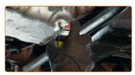
Atornille en el nuevo tapón de drenaje y apriételo. Use un vaso de impacto del n.º 19. Utilice una llave dinamométrica. Apriételo a un par de 30 Nm.
