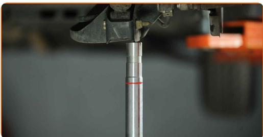
**7** Limpie las sujeciones del amortiguador. Use un cepillo de alambre. Use el aerosol WD-40.
