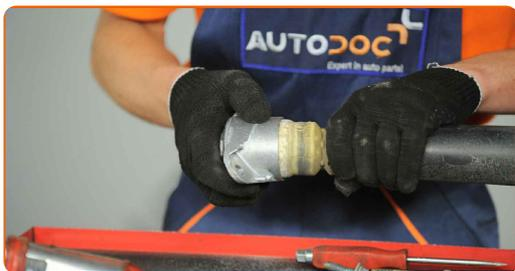
**17** Atornille la fijación superior de la varilla del amortiguador. Use un vaso de impacto del n.º 16. Utilice una llave dinamométrica. Apriételo a un par de 25 Nm.
