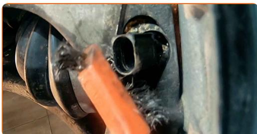
**8** Desenrosque la sujeción del sensor del ABS. Use Vaso HEX No. H5. Utilice una llave de trinquete.
