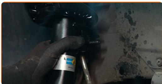
**66** Apriete la sujeción que conecta la bieleta de barra estabilizadora al amortiguador. Use una llave mixta del n.º 18. Use un vaso de impacto del n.º 18. Utilice las puntas XZN #6. Utilice una llave dinamométrica. Apriételo a un par de 55 Nm.
