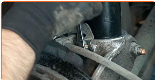
**63** Apriete la fijación inferior de la pata amortiguadora. Use un vaso de impacto del n.º 18. Utilice las puntas XZN #14. Utilice una llave de trinquete. Utilice una llave dinamométrica. Apriételo a un par de 70 Nm.+90°
