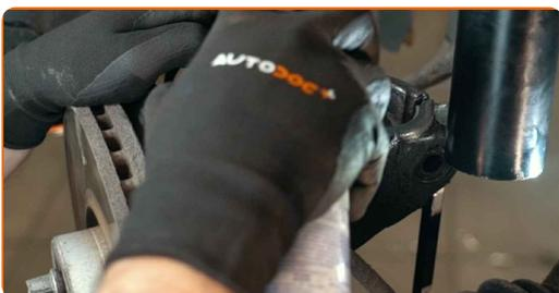
**53** Fije la pata amortiguadora en el muñón de dirección.
