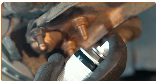
**69** Trate la superficie donde el disco del freno entra en contacto con la llanta de la rueda. Use grasa de cobre.
