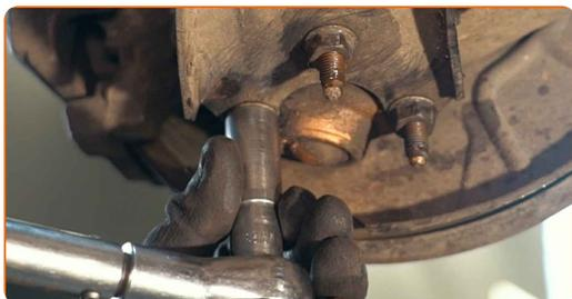
**62** Atornille la fijación del soporte del latiguillo de freno a la pata amortiguadora. Usa una llave mixta del n.º 10.
