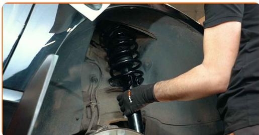
**51** Fije las sujeciones superiores del puntal amortiguador. No lo apriete.
