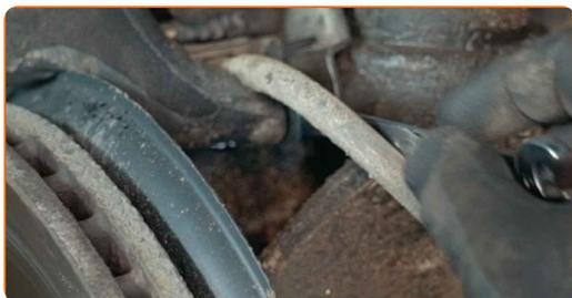
**18** Afloje la sujeción del eje de transmisión. Use un vaso de impacto del n.º 27. Utilice una llave de trinquete.
