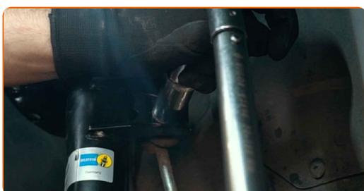
**67** Instale y apriete el perno del eje de transmisión. Use un vaso de impacto del n.º 27. Utilice una llave de trinquete.
