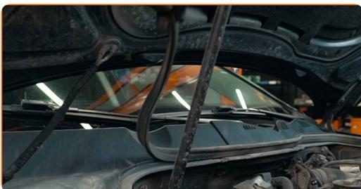
**4** Retire los clips de la rejilla de ventilación plástico del capó.
