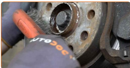
**63** Trate la superficie donde el disco del freno entra en contacto con la llanta de la rueda. Utilice grasa cerámica.
