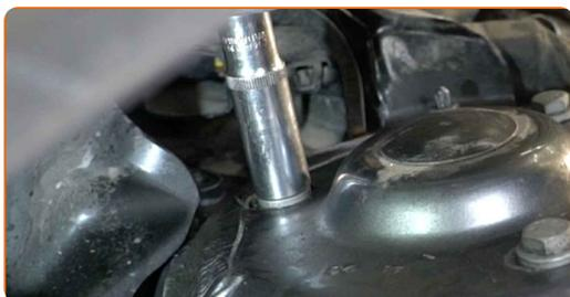
**70** Trate las sujeciones del soporte del amortiguador. Use grasa de cobre.
