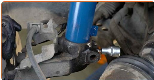
**45** Instale el perno de sujeción.
