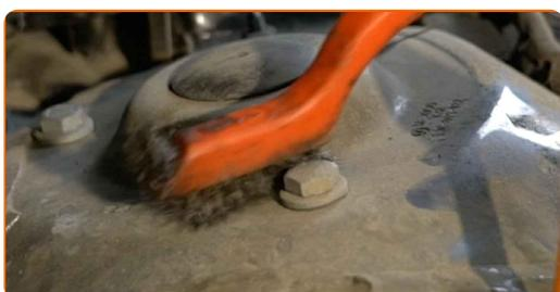
**7** Afloje las sujeciones superiores del puntal de suspensión. Use un vaso de impacto del n.º 13. Utilice una llave de trinquete.
