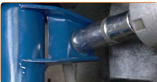
**55** Sostenga el muñón de dirección. Utilice un gato de transmisión hidráulica.
