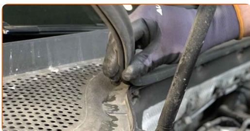
**4** Retire los clips de la rejilla de ventilación plástico del capó. Use una palanca.
