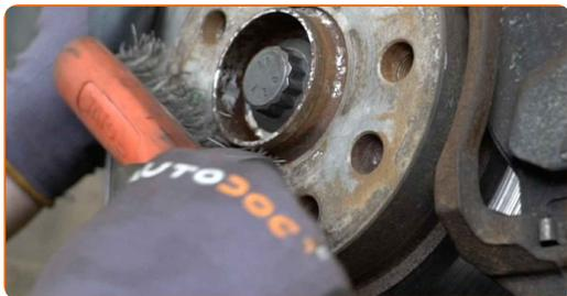
**68** Trate la superficie donde el disco del freno entra en contacto con la llanta de la rueda. Utilice grasa cerámica.
