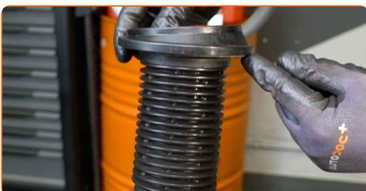
**41** Instale el soporte del puntal superior junto con el tope.
