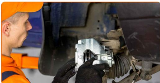
**18** Atornille los pernos guía. Use Vaso HEX No. H7. Utilice una llave dinamométrica. Apriételo a un par de 35 Nm.
