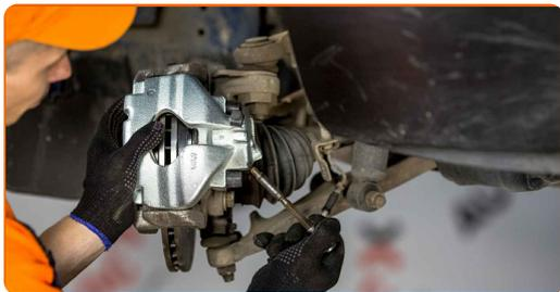
**Sustitución: pinza de freno - VW Transporter IV Camión de plataforma / Chasis (70E, 70L, 70M, 7DE, 7DL). Consejo de AUTODOC:**
