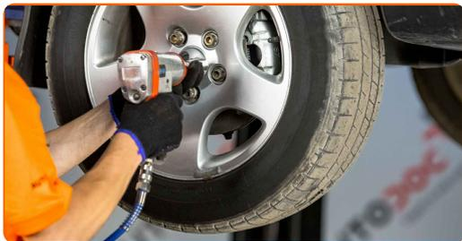
**31** Baje el automóvil y, manteniendo el orden cruzado, apriete los pernos de fijación de las ruedas. Utilice una llave dinamométrica. Apriételo a un par de 160 Nm.
