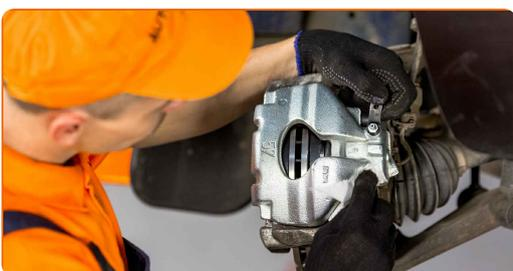
**25** Apriete el tornillo de purga de la pinza de freno. Usa una llave mixta del n.º 11. Utilice una llave dinamométrica. Apriételo a un par de 10 Nm.
