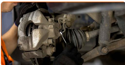
Sustitución: pinza de freno - VW Transporter IV Camión de plataforma / Chasis (70E, 70L, 70M, 7DE, 7DL). Consejo de los expertos de AUTODOC:
