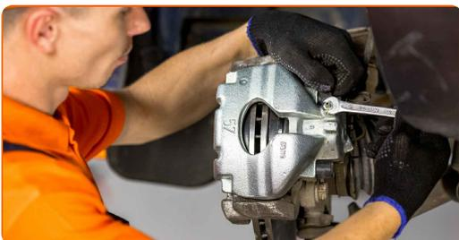
**24** Deje salir el aire del sistema del cáliper de freno. Sin poner el motor en marcha, empuje algunas veces el pedal del freno hasta el final, hasta que se note una resistencia considerable.
