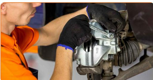
**26** Instale el resorte de fijación del cáliper de freno. Utilice un destornillador plano.
