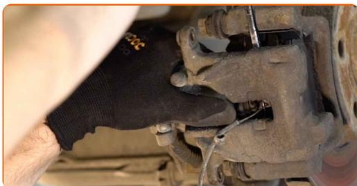
Sustitución: pastillas de freno - VW Transporter IV Camión de plataforma / Chasis (70E, 70L, 70M, 7DE, 7DL). AUTODOC recomienda:
