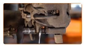
Desconecte la clavija del sensor de desgaste de las pastillas de freno.
