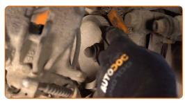
Destornille la fijación de la pinza del cáliper de freno. Use un vaso de impacto del n.º 18. Utilice una llave de trinquete. Utilice una llave giramachos.
