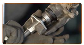
Instale las pastillas de freno. Conecte el captador de desgaste de las pastillas de freno.
