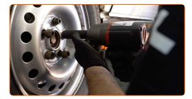
Baje el automóvil y, manteniendo el orden cruzado, apriete los pernos de fijación de las ruedas. Utilice una llave dinamométrica. Apriételo a un par de 170 Nm.
