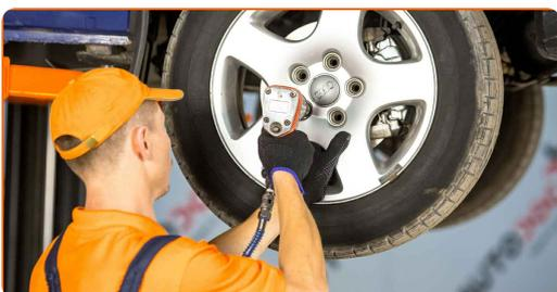
**45** Baje el automóvil y, manteniendo el orden cruzado, apriete los pernos de fijación de las ruedas. Utilice una llave dinamométrica. Apriételo a un par de 160 Nm.
