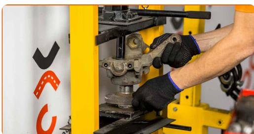
**29** Instale el muñón de dirección una vez ensamblado con el cubo.
