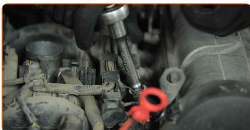
**12** Instale los conectores del cable de bujía en los pozos de la bujía. Asegúrese de que escucha un sonido clic indicando que está bloqueado en su lugar.
