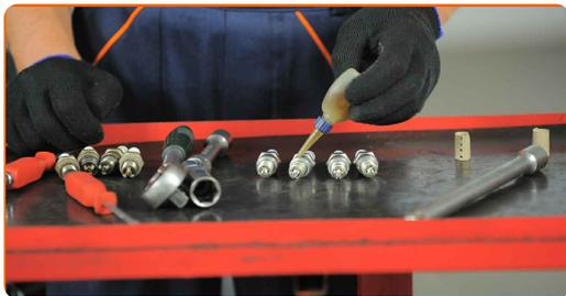
**10** Instale las nuevas bujías en sus asientos de montaje. Use el vaso de bujía # 21.
