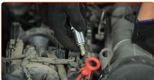
**11** Atornille las bujías nuevas y apriételas. Use el vaso de bujía # 21. Utilice una llave dinamométrica. Apriételo a un par de 25 Nm.
