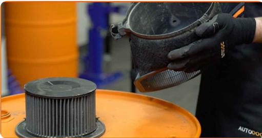
Sustitución: filtro de polen - VW Transporter T4 Camión de plataforma / Chasis (70E, 70L, 70M, 7DE, 7DL, 7D). Los profesionales recomiendan:
