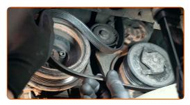
Vuelva a colocar la polea tensora en su posición inicial. Usa una llave mixta del n.º 16.
