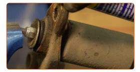
Destornille la fijación de la varilla del amortiguador. Usa una llave mixta del n.º 17.
