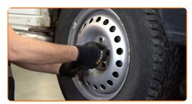
Baje el automóvil y, manteniendo el orden cruzado, apriete los pernos de fijación de las ruedas. Utilice una llave dinamométrica. Apriételo a un par de 170 Nm.
