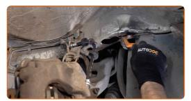
Coloque el amortiguador en el arco de la rueda y fíjelo.
