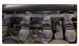
Levante la bobina de ignición haciendo palanca. Use una palanca.
