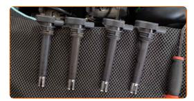
Trate la punta de la bobina de encendido. Utilice una grasa de alta temperatura. Utilice un destornillador plano.
