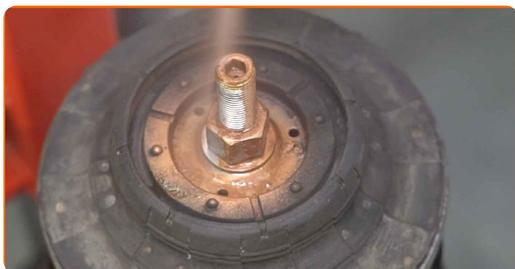
52 Retire el puntal amortiguador que está montado.
