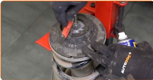
40 Destornille la tuerca de la varilla de la pata amortiguadora. Usa una llave mixta del n.º 21. Use Vaso HEX No. H7. Utilice una llave de trinquete.
