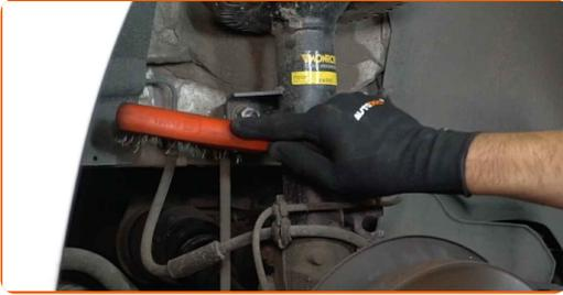
**20** Desatornille la sujeción que conecta la bieleta de barra estabilizadora al amortiguador. Use un vaso de impacto del n.º 18. Utilice una llave de trinquete.
