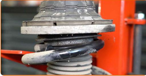
39 Trate la varilla del amortiguador. Use un cepillo de alambre. Use el aerosol WD-40.
