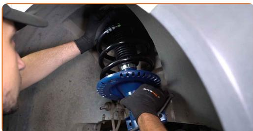
55 Atornille las sujeciones superiores del soporte del puntal de suspensión. No lo apriete.
