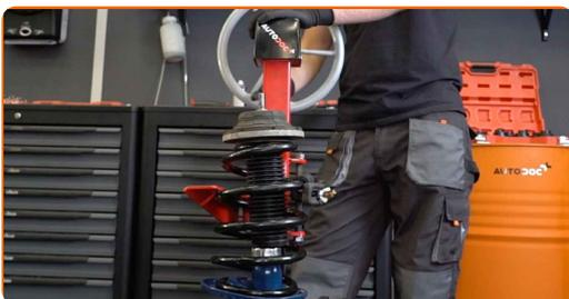
51 Trate la varilla del amortiguador. Use grasa de cobre.
