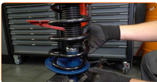
53 Limpie los asientos de montaje del amortiguador. Use un cepillo de alambre. Use el aerosol WD-40.
