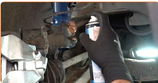
**74** Trate la superficie donde el disco del freno entra en contacto con la llanta de la rueda. Use grasa de cobre.
