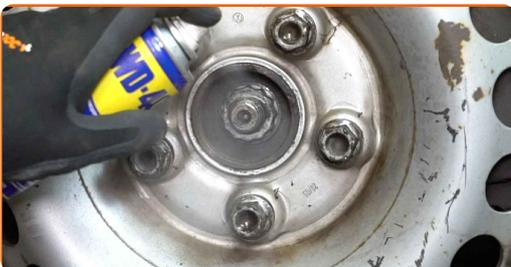
**15** Afloje la sujeción del eje de transmisión. Use un vaso de impacto del n.º 30. Utilice una llave giramachos.
