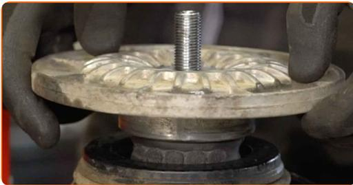
49 Apriete la tuerca de la varilla de la pata amortiguadora. Use un vaso de impacto del n.º 21. Use Vaso HEX No. H7. Utilice una llave dinamométrica. Apriételo a un par de 80 Nm.
