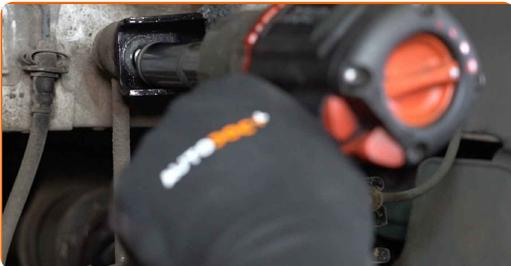
**21** Retire el enlace estabilizador de estabilidad transversal.
