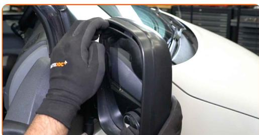
**3** Suelte con cuidado el cristal del espejo de su sujeción. Utilice una herramienta de recorte de plástico. Utilice un destornillador plano.
