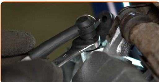
**31** Desconecte la manguera del kit de purgado de frenos.
