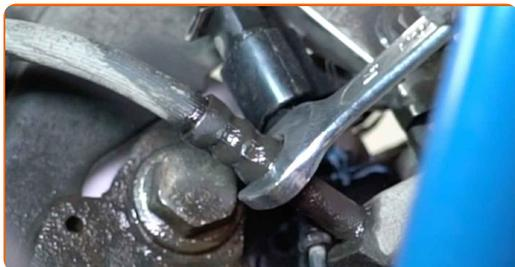
**14** Sujete el latiguillo del freno con una abrazadera de latiguillo de freno.
