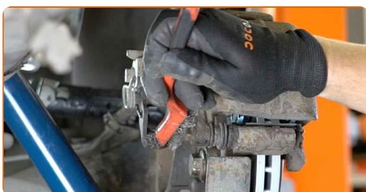
**12** Limpie el área donde el latiguillo de freno está conectada a la pinza de freno, y el área de los pernos guía. Utilice un cepillo de limpieza de nylon. Use un limpiador de frenos.
