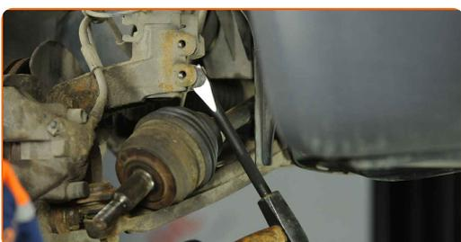
**24** Desconecte el muñón de dirección de la pata amortiguadora.
