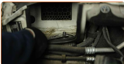
**64** Instale la tapa del soporte del amortiguador.
