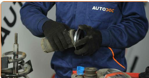
**55** Instale el soporte de montaje superior del puntal y el cojinete del soporte de montaje del puntal.
