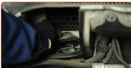
**65** Instale la cubierta protectora.
