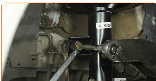
**90** Conecte la punta de la barra de dirección al muñón de dirección.
