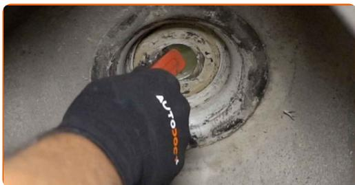
**61** Instale la pata amortiguadora en el arco de la rueda.
