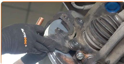
**24** Apriete la fijación de la pinza del cáliper de freno. Use un vaso de impacto del n.º 21. Utilice una llave dinamométrica. Apriételo a un par de 180 Nm.+45°
