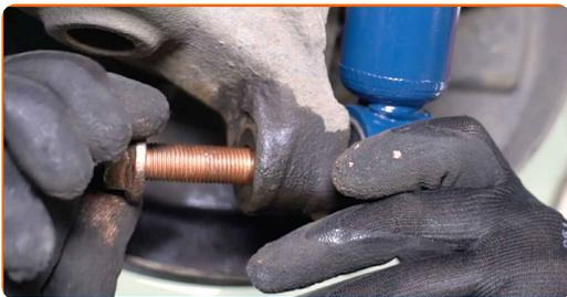
**18** Apriete la fijación inferior del amortiguador. Usa una llave mixta del n.º 21. Use un vaso de impacto del n.º 21. Utilice una llave dinamométrica. Apriételo a un par de 120 Nm.+90°
