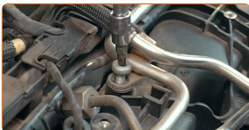
**6** Separe el arnés de cables del motor. Utilice un destornillador plano.
