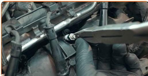
**16** Apriete las bujías de precalentamiento. Use el vaso de bujía # 10. Utilice una llave dinamométrica. Apriételo a un par de 18 Nm.
