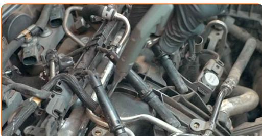
**10** Trate las bujías de precalentamiento. Use el aerosol WD-40.
