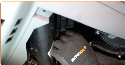
**9** Atornille las sujeciones de la cubierta de la carcasa del filtro de habitáculo. Use un vaso de impacto del n.º 5,5. Utilice una llave de trinquete.
