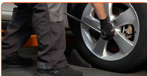
4 Levante la parte trasera del automóvil y fije la posición sobre los pedestales.
