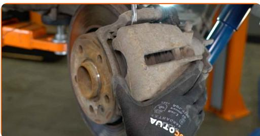
**10** Retire el soporte de freno. Use una palanca.
