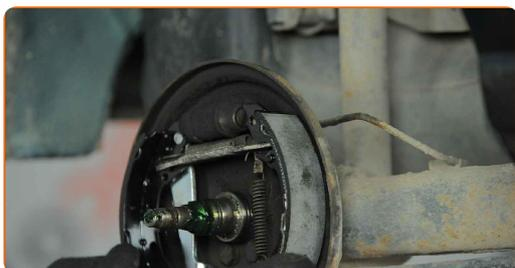
**23** Instale los clips de retención de las pastillas de freno. Utilice alicates.
