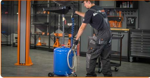
5 Destornille el tapón de desagüe. Utilice un vaso de impacto n° 19 o una llave de estrella n° 19. Vierta el aceite usado.
