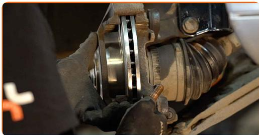
**25** Apriete la fijación de la pinza del cáliper de freno. Use un vaso de impacto del n.º 21. Utilice una llave dinamométrica. Apriételo a un par de 162 Nm.
