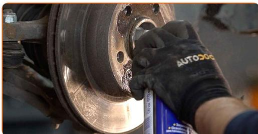
**17** Destornille la fijación del disco de freno. Utilice un destornillador Phillips. Utilice un destornillador de impacto.
