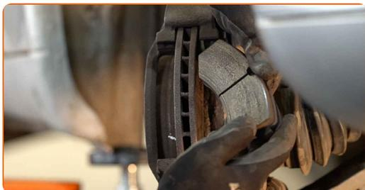
**13** Limpie las sujeciones del soporte de la pinza del freno. Use un cepillo de alambre. Use el aerosol WD-40.
