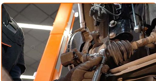
**26** Trate el pistón de la pinza de freno. Use el aerosol WD-40.
