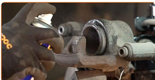
**27** Empuje hundiendo el cáliper de freno. Utilice la herramienta de retorno del pistón de freno.
