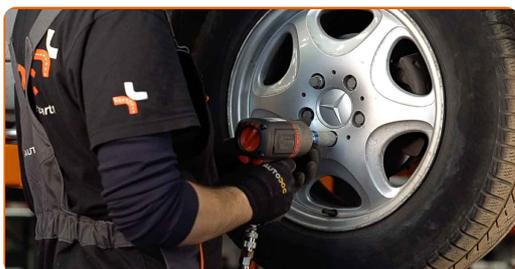
**35** Baje el automóvil y, manteniendo el orden cruzado, apriete los pernos de fijación de las ruedas. Utilice una llave dinamométrica. Apriételo a un par de 175 Nm.
