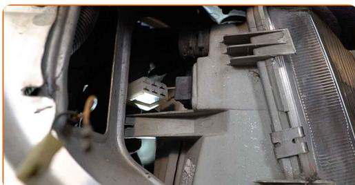
9 Desconecte la manguera de vacío del ajustador de faros delanteros. Use alicates de punta redondeada.
