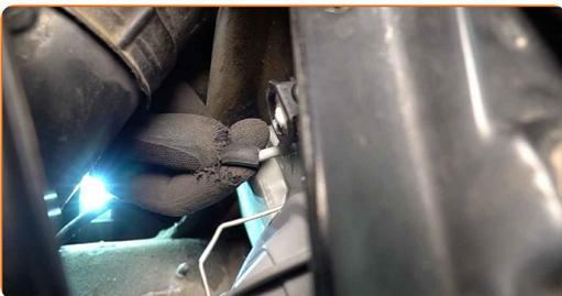
23 Trate los conectores de los faros delanteros. Utilice spray para electrónica.
