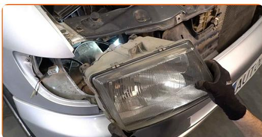
**12** Desconecte el retenedor de la cubierta protectora del faro.
