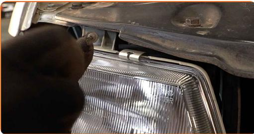
22 Conecte la manguera de vacío al ajustador del faro delantero.
