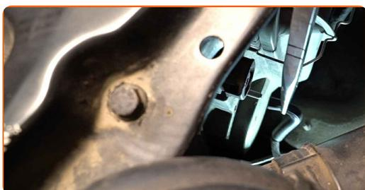
**10** Desatornille las sujeciones del faro delantero. Utilice un destornillador Phillips.
