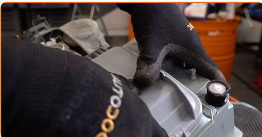
19 Conecte el retenedor de la cubierta protectora del faro delantero.
