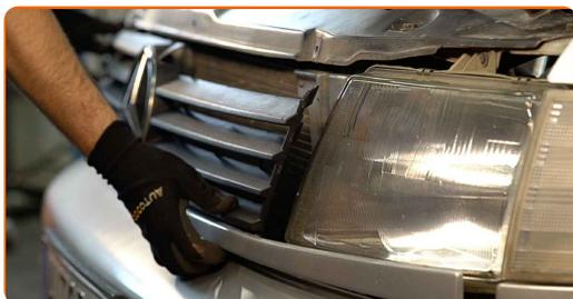
6 Retire la sujeción de la luz indicadora de giro (intermitente). Use alicates de punta redondeada.
