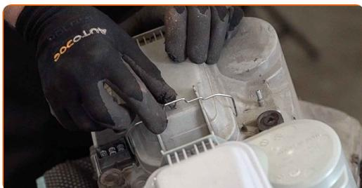
**13** Retire la cubierta trasera del faro.
