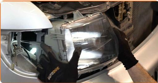
21 Atornille en las sujeciones del faro delantero. Utilice un destornillador Phillips.
