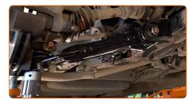
Apriete la sujeción delantera que conecta el brazo de control al subchasis. Use un vaso de impacto del n.º 19. Utilice una llave dinamométrica. Apriételo a un par de 155 Nm.
