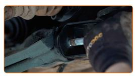
Destornille la fijación trasera de la palanca. Usa una llave mixta del n.º 21. Use un vaso de impacto del n.º 19. Utilice una llave de trinquete.
