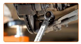
Desatornille y retire las sujeciones de la cubierta del paso de rueda. Use un vaso de impacto del n.º 8. Utilice una llave de trinquete.
