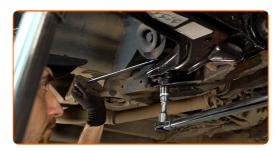
Apriete la fijación del soporte esférico. Usa una llave mixta del n.º 21. Utilice una llave dinamométrica. Apriételo a un par de 162 Nm.
