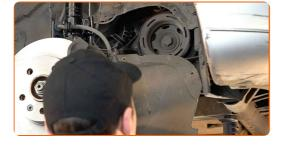
Destornille la fijación delantera de la palanca. Usa una llave mixta del n.º 18. Use un vaso de impacto del n.º 19. Utilice una llave de trinquete.
