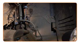
Instale y apriete las sujeciones de la cubierta del paso de rueda. Use un vaso de impacto del n.º 8. Utilice una llave de trinquete.
