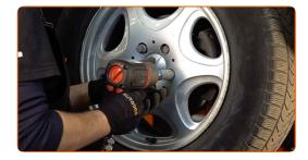
Baje el automóvil y, manteniendo el orden cruzado, apriete los pernos de fijación de las ruedas. Utilice una llave dinamométrica. Apriételo a un par de 175 Nm.
