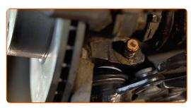
Atornille la fijación trasera de la palanca. Use un vaso de impacto del n.º 19. Usa una llave mixta del n.º 21. Utilice una llave de trinquete.
