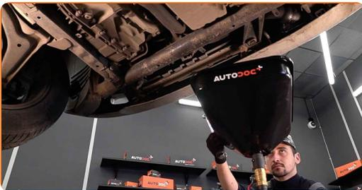
7 Destornille el tapón de desagüe. Usa una llave mixta del n.º 13.
