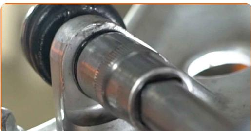
**8** Desatornille la sujeción que conecta la bieleta a la barra estabilizadora. Usa una llave mixta del n.º 17. Use Vaso HEX No. H6. Utilice una llave de trinquete.
