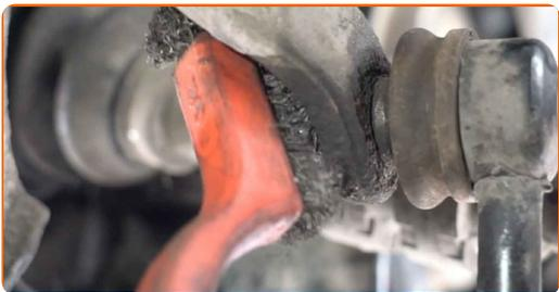
**7** Desatornille la sujeción que conecta la bieleta de barra estabilizadora con el brazo de control. Use un vaso de impacto del n.º 17. Utilice una llave de trinquete.
