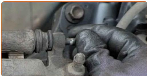
**22** Apriete las sujeciones de la pinza del freno. Use un vaso de impacto del n.º 14. Utilice una llave dinamométrica. Apriételo a un par de 32 Nm.
