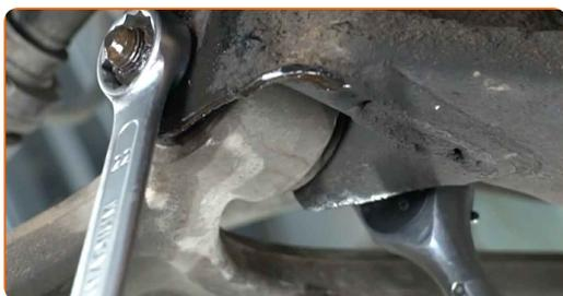
**14** Desenrosque las sujeciones traseras del brazo. Use un vaso de impacto del n.º 19. Utilice una llave de trinquete.
