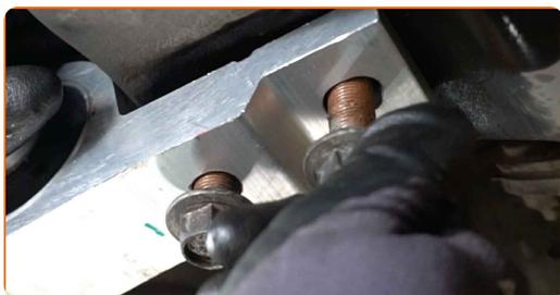
**22** Sostenga el muñón de dirección. Utilice un gato de transmisión hidráulica.
