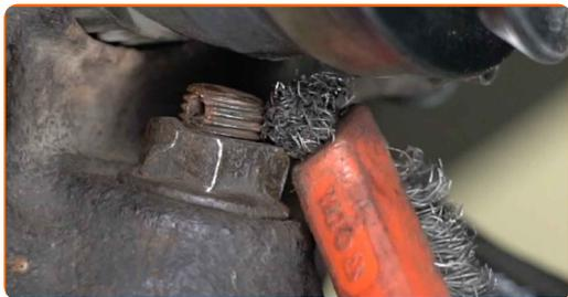
**11** Destornille la fijación del soporte esférico del muñón de dirección. Usa una llave mixta del n.º 22.
