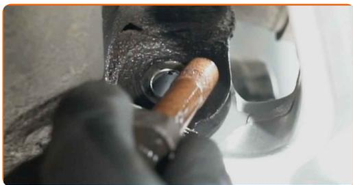
**20** Conecte el apoyo esférico al muñón de dirección.
