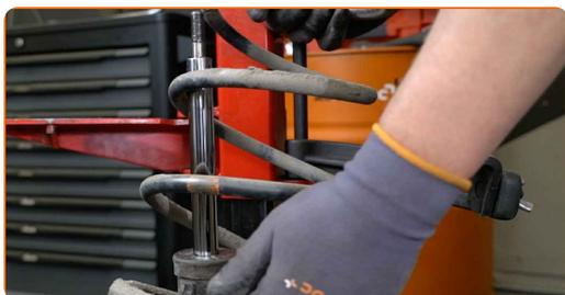
**29** Retire el amortiguador viejo del compresor de muelles hidráulico.
