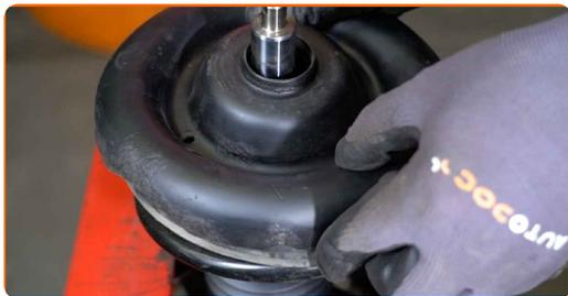
**34** Instale el soporte de montaje superior del puntal y el cojinete del soporte de montaje del puntal.
