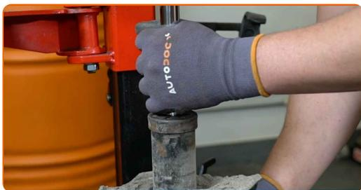
**30** Instale el nuevo amortiguador en el compresor de muelles hidráulico.
