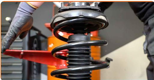
**37** Trate la varilla del amortiguador. Use grasa de cobre.
