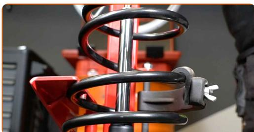
**33** Instale el guardapolvo y el tope en el amortiguador nuevo.
